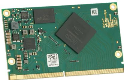
Das miriac® MPX-S32Z2 basiert auf der NXP® S32Z2 CPU, die herausragende Echtzeitfähigkeiten bereitstellt. (Bild: MicroSys)
